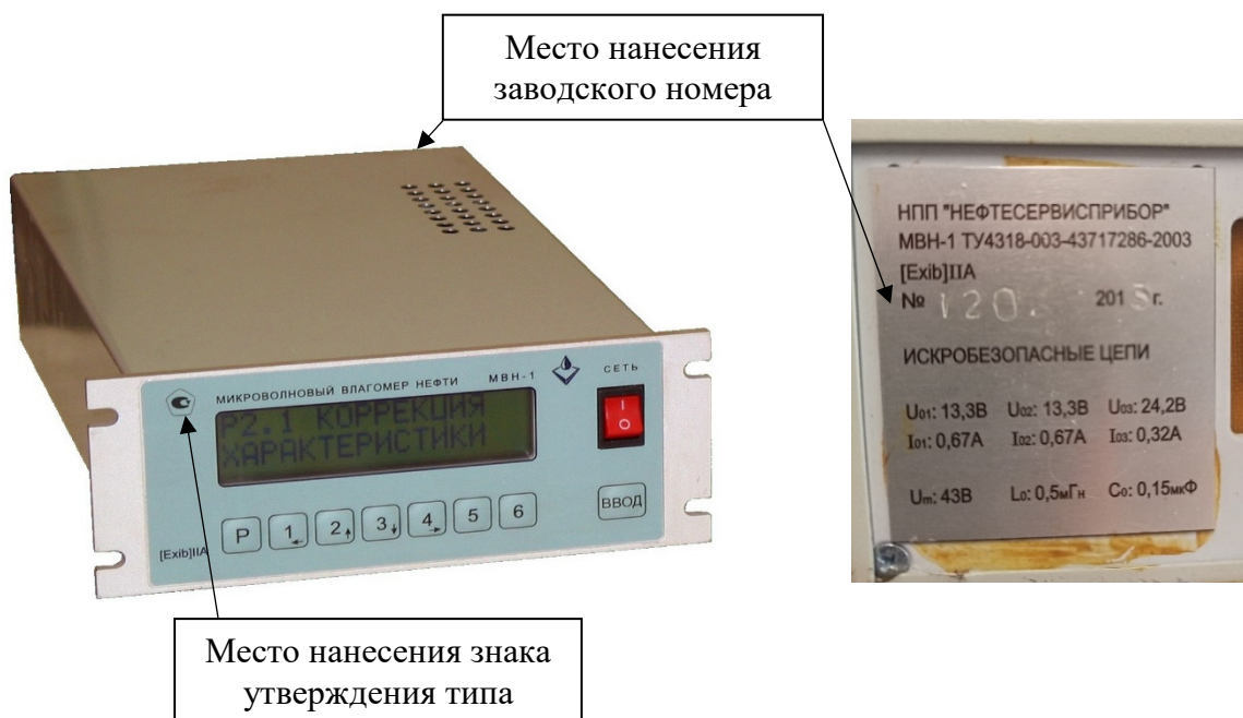
Рисунок 2 – Блок обработки влагомера MBH-1 с указанием мест нанесения знака утверждения типа и заводского номера
